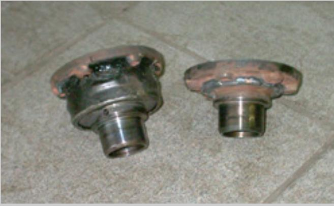
Auf dem linken Bild sind das Renaultgelenk und ein Busflansch zu sehen. Sie werden passend abgeschnitten, ineinander verpresst und verschweisst. Auf dem rechten Bild sieht man das Ergebnis. Die Flansche sind nicht symmetrisch! Das liegt daran, dass das Busgetriebe im Gegensatz zum Renaultgetriebe nicht symmetrisch gebaut ist. Baut man nun ein Renaultgetriebe an eine Busglocke, so liegt es nicht genau in der Mitte. Das muss mit den Flanschen wieder ausgeglichen werden.
