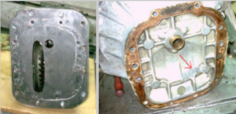
Eine 15mm dicke Adapterplatte reicht nicht um das Tellerrad ganz abzudecken. Mit einer dickeren Platte würde die Motor-Getriebeeinheit aber noch länger, also muss man etwas Material
