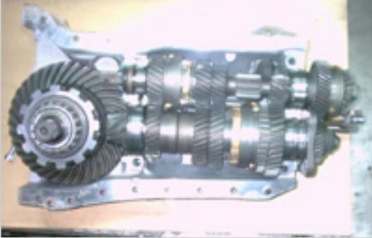
Sind die Innereien gut geölt und das Getriebe nicht durch zwei gleichzeitig eingelegte Gänge gesperrt, kann das Gehäuse geschlossen werden. Abgedichtet wird es durch auftragen ein flüssigen silikonartigen Masse (Easy Gasket) auf die Planflächen. Ist alles zusammengebaut und die Gänge lassen sich immernoch schalten, so ist das Getriebe für den weiteren Umbau bereit.
