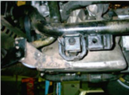
Nach dem Versetzen des Motors könnten unter Umständen die Kühlwasserrohre, die Spritleitung oder sonstige Leitungen und Kabel zu sehr gespannt sein. Das sollte geprüft und gerichtet werden. Die Leitungen sind eigentlich lang genug, müssen vielleicht etwas verschoben werden. Die Zahnriemenabdeckung ist jetzt auch weiter hinten und schlägt an die Karosserie. Es muss etwas mehr Platz geschaffen werden (mit einem grossen Hammer z.B)
