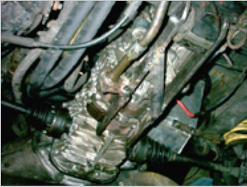
Das Gestänge muss gekürzt werden ,so dass man eine vernünftige Leerlaufstellung bekommt und der Knick im Gestänge weiter nach vorne kommt. Ansonsten vorne in der Schaltkulisse die Führungen entfernen und die Schaltung so einstellen ,dass sich Rückwärts und 5ter Gang einlegen lassen. Hat man es soweit gebracht, dann werden sich die anderen Gänge auch schalten lassen. Wenn man Lust hat, kann man neue Führungen in die Schaltkulisse bauen.Das Schaltschema ist wie folgt:
